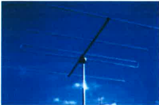
Obr. 1.4 – smerová anténa pre RDS prijímač
